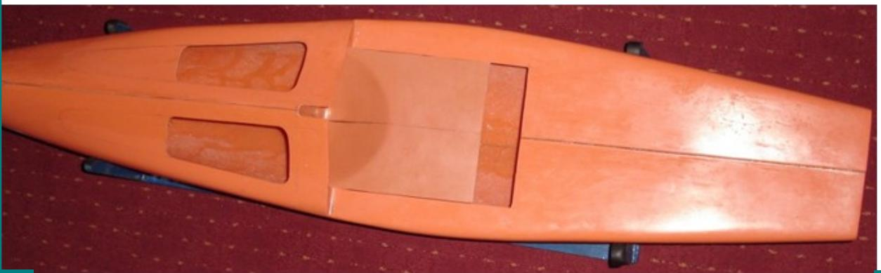
Izrada ostalih djelova opute, kalup za škacu jarbola, kalup za škacu kobilice, dijelovi palube.
