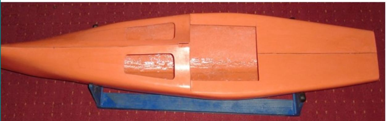
Izljevak se izrađuje od istog materijala kao i kalup samo što se ovdje koristi što manje materijala kako bi izljevak bio lagan, a za kalup je važno da je krut. Nakon izrade lijeve i desne strane izljevka one se spajaju u jednu cjelinu kao na slici.
