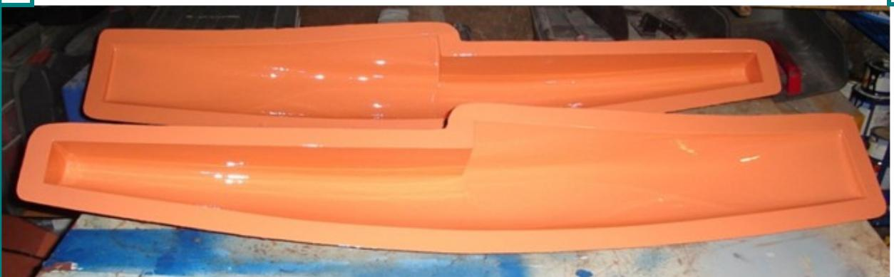
Unutarnji izgled kalupa nakon sušenja i odvajanja od modela. Nakon toga slijedi izrada izljevkha koji je u ovom slučaju iz dvije polutke.
