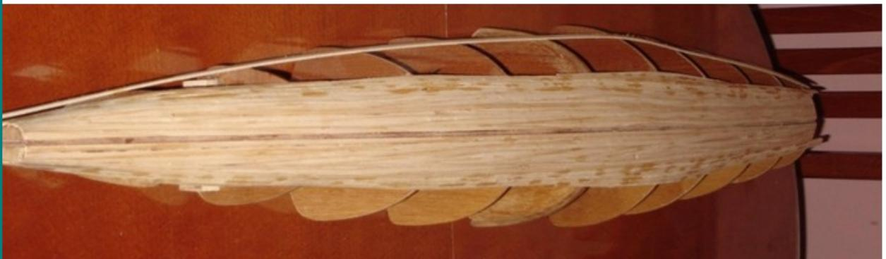
Letvice moraju biti tanke i dugačke preko metra. Lijepe se od provenog dijela prema krmenom dijelu cijelom dužinom.
