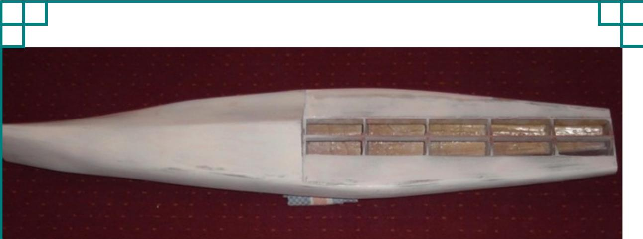
Nakon izrade modela, model se fino obrađuje, na njega se postavlja kit koji ulazi u svaku poru drveta i zakrpava sve rupice tako da sve postane jedno tijelo. Nakon sušenja slijedi fino brušenje i ispravljanje pogrešaka.
