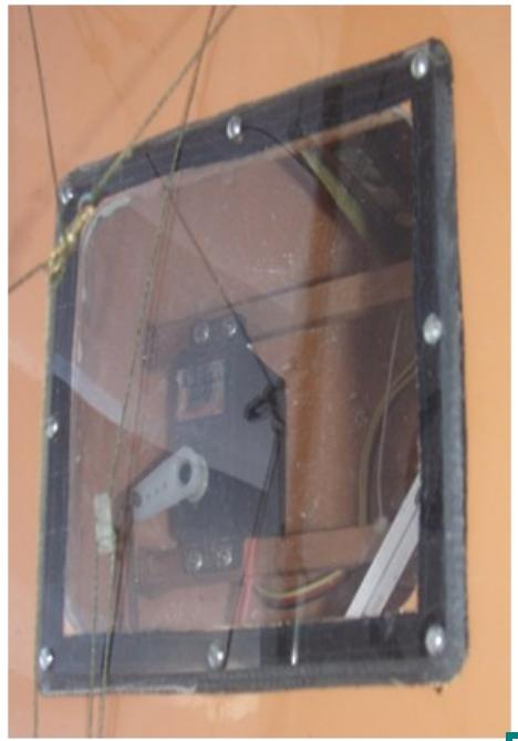
**Postavljanje elektronike** - dva servo elektromotora, jedan za upravljanje kormilom, a drugi za natezanje i otpuštanje škote. Dozvoljene su samo standardne jačine. Izgled poklopca (portelete) kojim se zatvaraju otvor, izrađeni su od plastike i termo trake koja služi da hermetički zatvori otvor. Otvor je pričvršćen vijcima.
