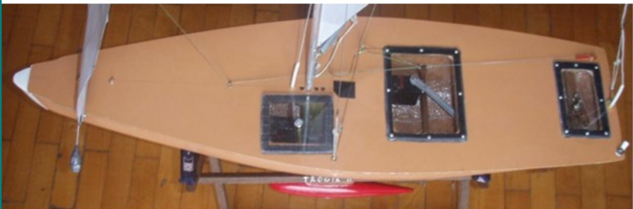
Slijedi **lijepljenje palube** i izrezivanje otvora, postavljanje okova, brušenje tehnološkog viška. Otvori se mogu zatvoriti poklopcima izrađenim od plastike i samoljepljivog materijala.
