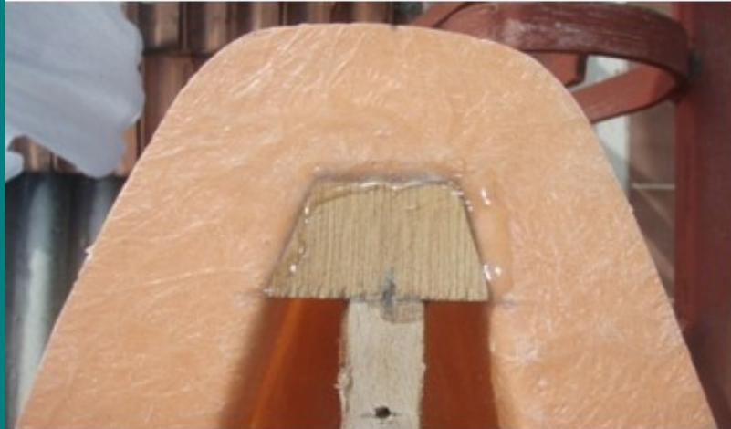
Slijedi lijepljenje tzv. „slova T“ sastavljeno od letvice koja spaja polovicu trupa i središnjicu. Mogu se zalijepiti i dodatne dvije letvice koje će služiti kao otvor na palubi.
