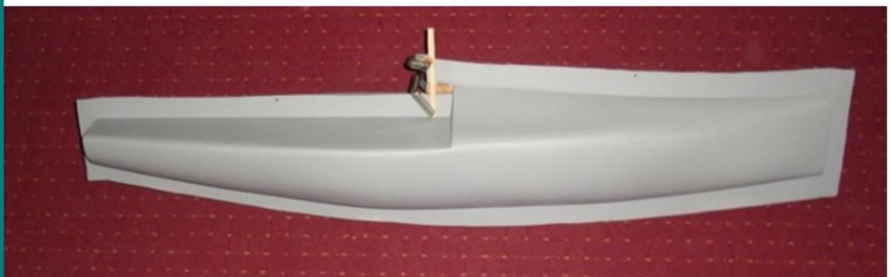
Dovođenje modela do savršenstva, finiširanje te izrada kalupa. Vanjski izgled kalupa (dolje) nakon što je nalijepljen preko modela izrađuje se od staklene vune i epoxi smole (dolje).
